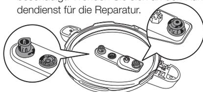
4. Die Anzeige für das Druckniveau wird nicht korrekt angehoben (obwohl der Dampfkochtopf Druck aufbaut). In diesem Fall reinigen Sie die Zone vorsichtig mit einer Nadel.
