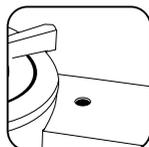
6.2 Ak zvolíte stupeň tlaku 1, indikátor stupňa tlaku vystúpi až k prvej čiarkе. Keď sa táto čiarka objaví, nastavte adekvátnu teplotu tak, aby sa tlak udržal na tejto značke a dochádzalo len k minimálnemu úniku pary.
