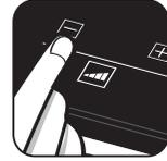
**6.3** Wenn Sie das Druckniveau **2** wählen, wird der Anzeiger für das Druckniveau bis zum zweiten Strich angezeigt. Ist dieser sichtbar, stellen Sie die Hitzezufuhr auf die Höhe ein, dass die Hitze gehalten wird und kein Dampf austritt.
