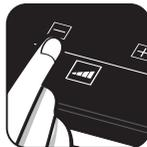
6.3 Keď zvolíte stupeň tlaku 2, indikátor stupňa tlaku vystúpi až k druhej čiarkе. Keď sa táto čiarka objaví, nastavte adekvátnu teplotu tak, aby sa tlak udržal na tejto značke a dochádzalo k minimálnemu úniku pary.
