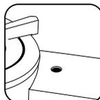
6.2 Pokud zvolíte stupeň tlaku 1, indikátor stupně tlaku vystoupí až k první čáře. V momentě, kdy je tato viditelná, zregulujte teplotu na adekvátní stupeň tak, aby se tlak udržel na této značce a nedocházelo k úniku páry.
