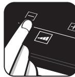
6.3 Když zvolíte stupeň tlaku 2, indikátor stupně tlaku vystoupí až k druhé čáře. V momentě, kdy je tato viditelná, zregulujte teplotu na adekvátní stupeň tak, aby se tlak udržel na této značce a nedocházelo k úniku páry.
