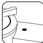
**6.2** Si vous sélectionnez le niveau **1** de pression, l'indicateur du niveau de pression montera jusqu'à la première ligne. Une fois la deuxième ligne visible, réglez la source de chaleur, afin de maintenir le niveau de pression sans dégagement de vapeur.
